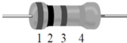
**Figura 3.21** Código de cores para resistores fixos.
